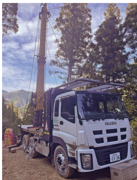
トラック搭載型タワーヤーダ
